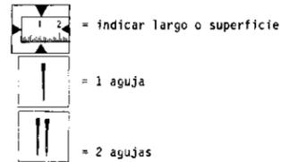
2.2 Para los ribeteadores hay que indicar el ancho de la cinta, para las guarniciones de 2 agujas, la distancia entre agujas, y para los elementos de corte, la distancia de corte.
