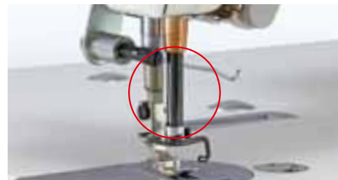
Igielnica wykończona specjalną obróbką powierzchni
