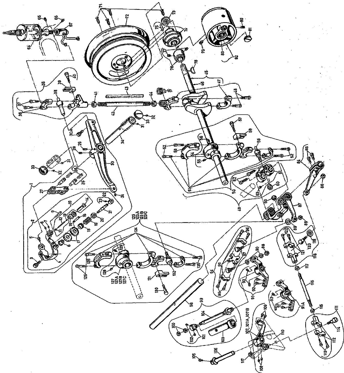
NADELHEBEL, HANDRAD, KURBELWELLE UND GREIFERANTRIEB
