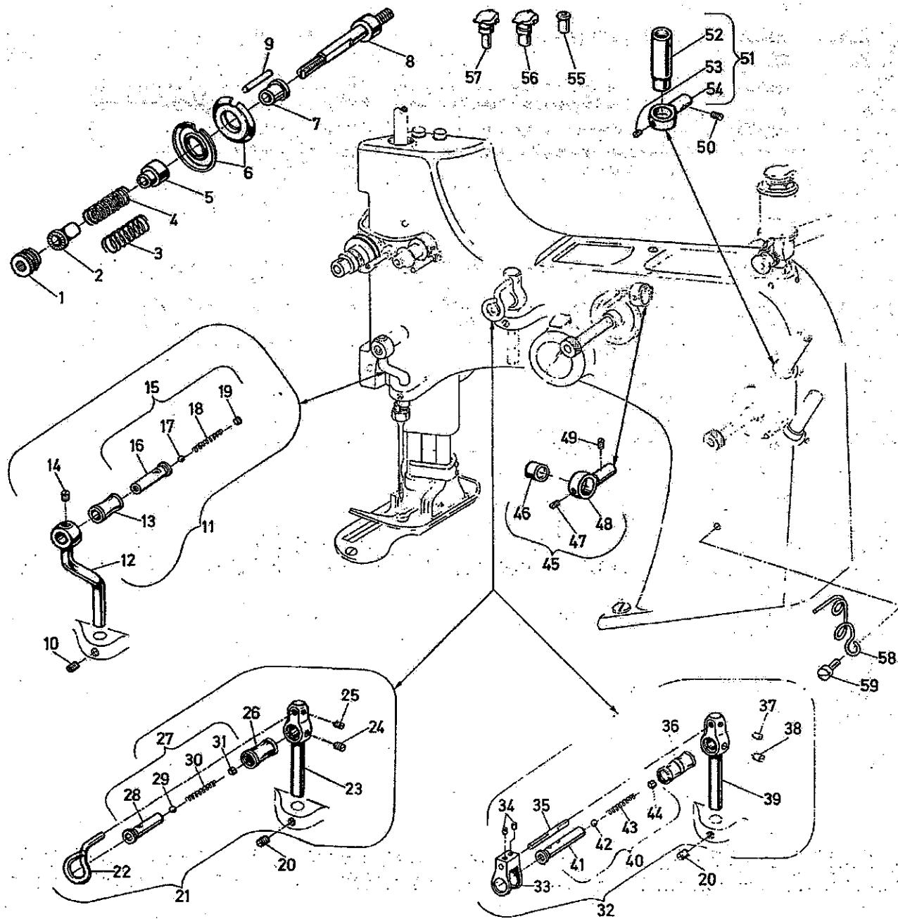
VERSCHIEDENE FÄDENFÜHRUNGEN UND FADENSPANNUNGEN
