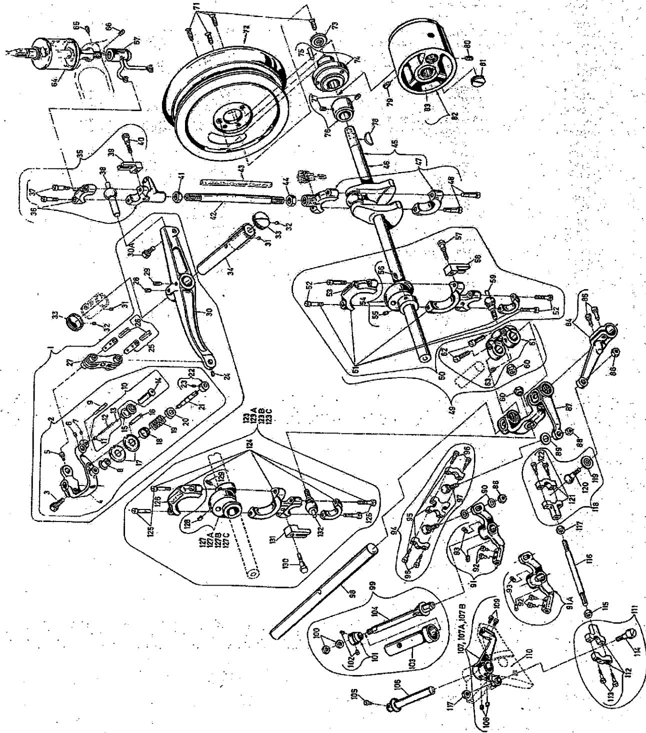
**NADELHEBEL, HANDRAD, KURBELWELLE UND GREIFERANTRIEB**
